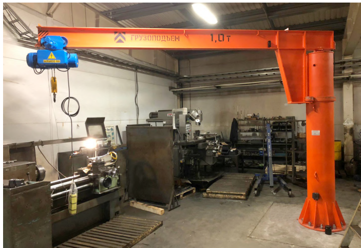
Кран консольный на колонне с ручным приводом на поворот консоли грузоподъемностью 1,0 тонна для предприятия в Рязани.
