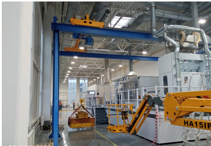
Кран мостовой опорный с электроприводом грузоподъемностью 2,0 тонны в комплекте с подкрановой эстакадой длиной 10,7 метров для предприятия в Московской области.
