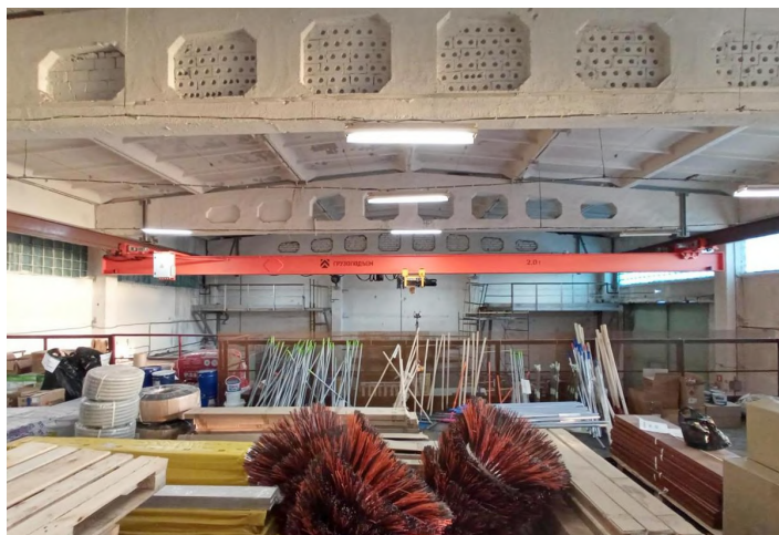
Кран мостовой подвесной однопролетный с электроприводом грузоподъемностью 2,0 тонны и длиной пролета 15,0 метров для предприятия в Мурманской области.
